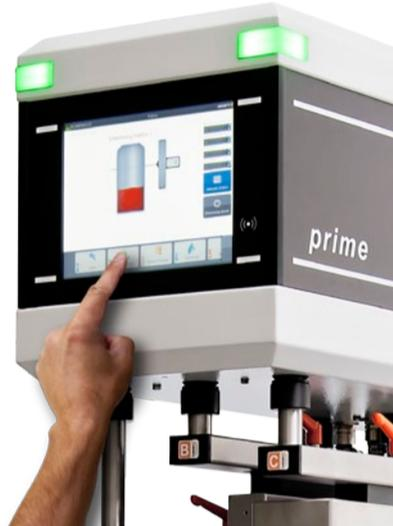
Den Füllstand kontrollieren und den Innendruck messen; die Anwesenheit, den Sitz und die Dichtigkeit von Verschlüssen überprüfen; unetikettierte Behälter, Bottle-Bursts und Serienfehler erkennen; fehlerhafte Getränkeverpackungen konsequent ausleiten: Der modular aufgebaute HEUFT *prime* bietet alle Funktionen, die eine Vollgutkontrolle braucht.
