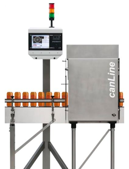
Nicht sicher verschließbare, verformte und mit Fremdkörpern belastete Leerdosen werden sicher identifiziert.
