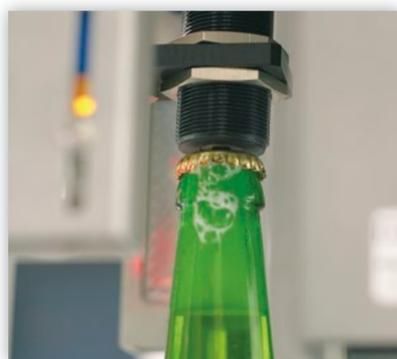
Auch die Anwesenheit und Integrität von Verschlüssen wird überprüft.
