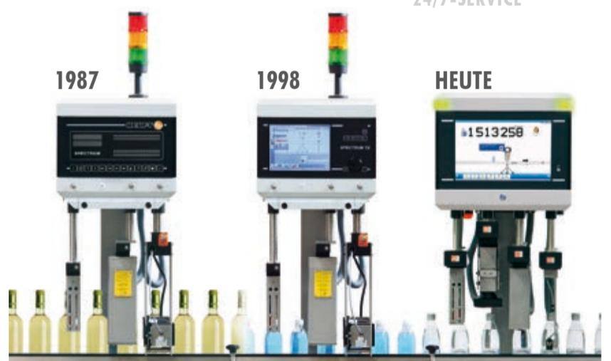
passen sich sämtliche Erkennungen von selbst an die jeweils gefahrene Sorte an. Manuelle Eingriffe sind nicht mehr erforderlich! Der HEUFT ISI-Bus minimiert den Verdrahtungsaufwand und vereinfacht so die Montage und Nachrüstung erheblich. Wie gewohnt, kann man sich auf eine geräteübergreifende Ersatzteilgleichheit von 70 Prozent und eine Verfügbarkeit aller Komponenten von mindestens zwölf Jahren verlassen. Unser eigenes Betriebs-
