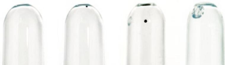
„Schwarzbrenner“, Beschädigungen am Ampullenspieß und viele weitere Fehler in befüllten Pharmaverpackungen identifiziert der neue HEUFT *spotter PH*.
