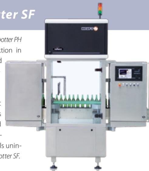
Dichte, die frei im Produkt schweben, wie etwa Folienreste und Papierfetzen, Insekten und Schimmel. Auch Kratzer, Risse, Einschlüsse, Ausbrüche und Absplitterungen können bei der lückenlosen Boden- und Seitenwandinspektion mit dem HEUFT *spotter SF* erkannt werden.
